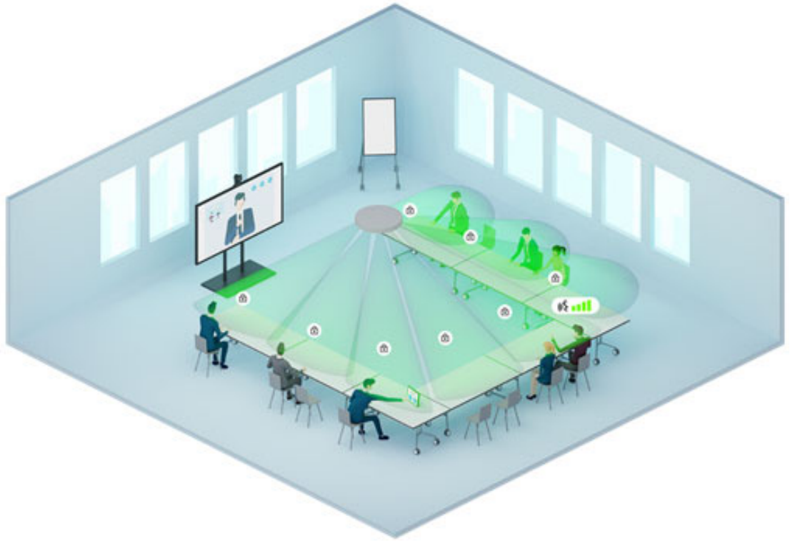
Micrófono de techo con múltiples zonas de formación de haces
